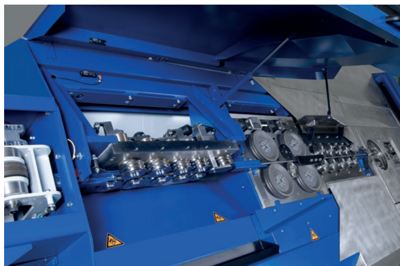
Ein horizontales und ein vertikales Richtwerk, automatisch einstellbar, sorgen für sehr gute Richtergebnisse.
