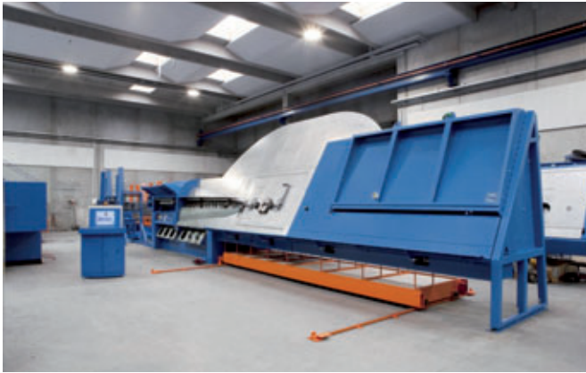
Betonstahl- Bearbeitungszentrum Twinmaster 20- ausgestattet mit Anti-stress-Einheit und Antitwist-Vorrichtung sowie neuen Richtwerken mit getrennten Antrieben. Verarbeitet Ringmaterial bis 20 mm Durchmesser.
