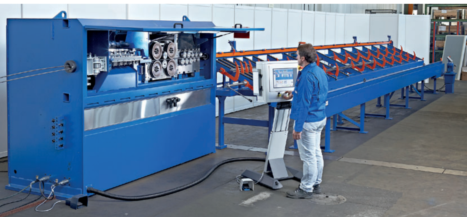
Rollenrichtanlage Twincut 12, ausgestattet mit Stabablage für die gerichteten und geschnittenen Längen.
