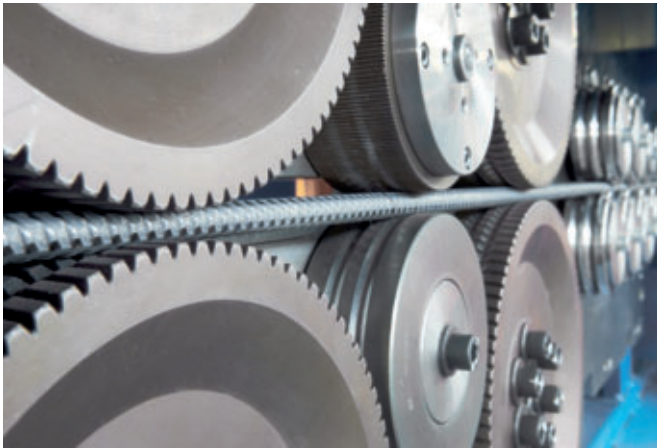
Stabile, leistungsstarke Antriebsstationen und Messeinrichtung für genaue Längen
