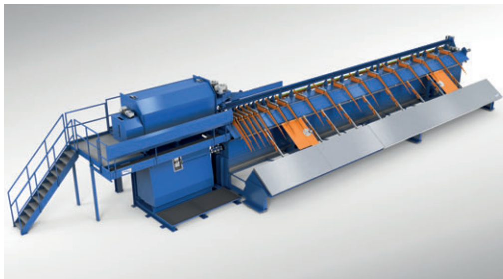
Pedax-Bearbeitungszentrum für Betonstahl-Bearbeitung vom Ring. Die neue vollautomatische Anlage vereinigt eine Richtanlage mit automatischen, hyperbolischen Rotoren, einen Doppelbieger und einen Bügelbieger zu einem Zentrum.
