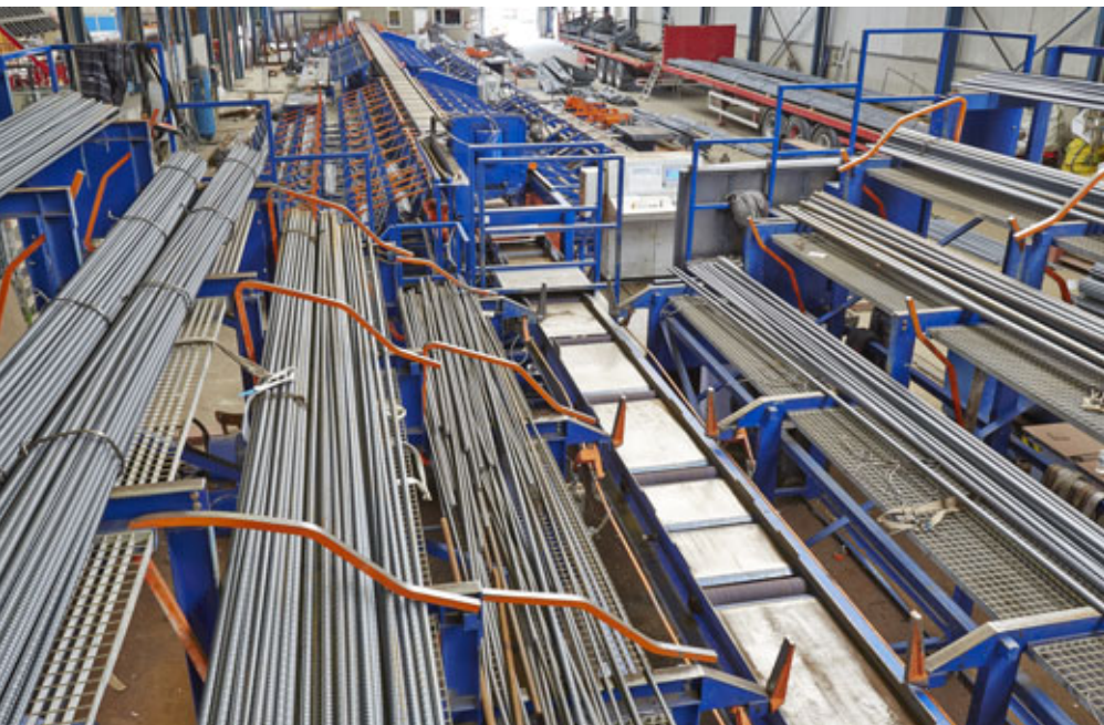
Bild 1: Stationäre Cadormatic 500-Stangenschneidanlage als Mengenschneidsystem mit integrierten Biegeautomaten
