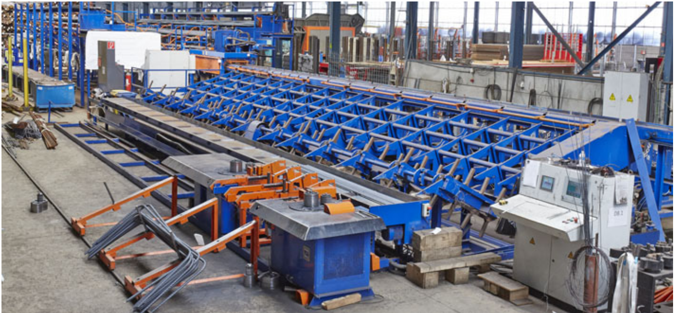
Bild 2: Über Pocketsysteme und über Kettenquerfördereinrichtungen erreichen Biegelängen Doppelbiegeanlagen. Bei dieser Anlage sind gleich zwei Doppelbiegeanlagen eingebunden.
