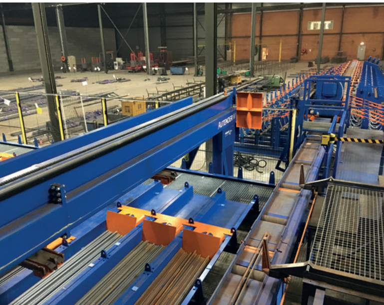
Servogeregelter Transport der Stangen bis 120m/min
