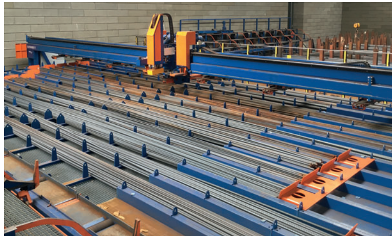
Die geschnittenen Stäbe werden von der Cadomatic 500 weiter zu den Hakenfangsystemen für Biegeprozesse oder in Sammelmulden transportiert.
