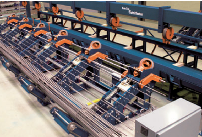
Pedax Spinmaster zur automatischen Produktion von Rollmatten. Die Längsstäbe werden mittels Drahrödeltechnik automatisch miteinander verbunden, sie werden nicht verschweißt.
